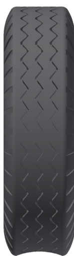
Falta de pressão
